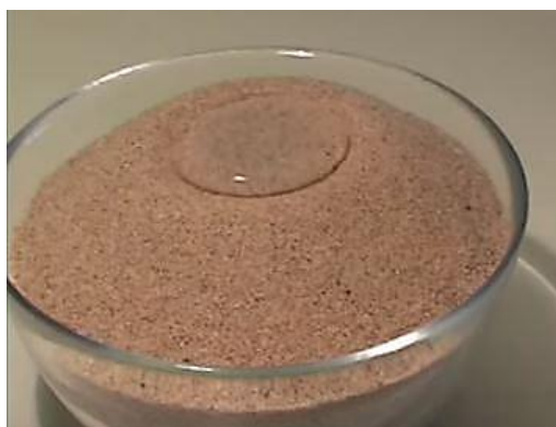
شکل ۱: نمایی از ماسه هایدروفوبیک مقاوم در برابر نفوذ آب
